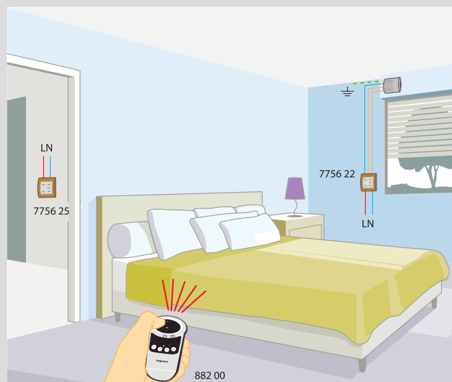
Контрол на щори в нова сграда (решение с помощта на КСА)
